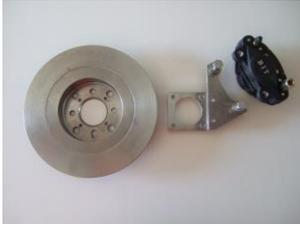
Bremsscheiben, Halter für Bremssattel, Bremssattel,
