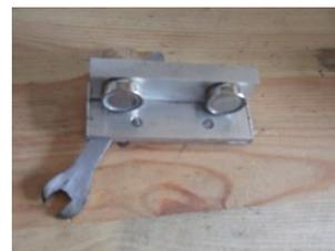
Für die Einstellschraube und Kontermutter benötigt man zwei Gabelschlüssel. Da der Ventilstößel aber drehbar ist, benötigt man noch einen 3. Gabelschlüssel. Mit drei Gabelschlüssel gleichzeitig hantieren ist sehr schwer. Daher hilft diese Vorrichtung mittels Magneten den 3. Gabelschlüssel am Motorblock zu fixieren.
